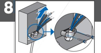
Heizkabel einführen, Zugentlastung festziehen
