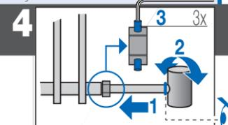
**4** O-Ring kontrollieren, Heizstab einführen, ausrichten, fixieren
