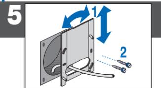
Zwischenplatte ausrichten und festschrauben
