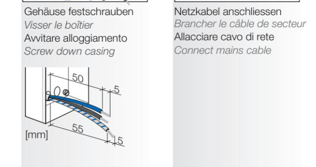
Anschluss gemäß Anschluss-Schema
