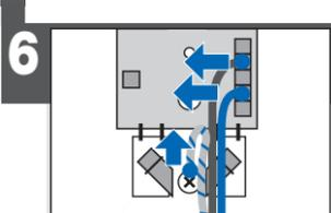
**6** Netzkabel lösen, ablängen
